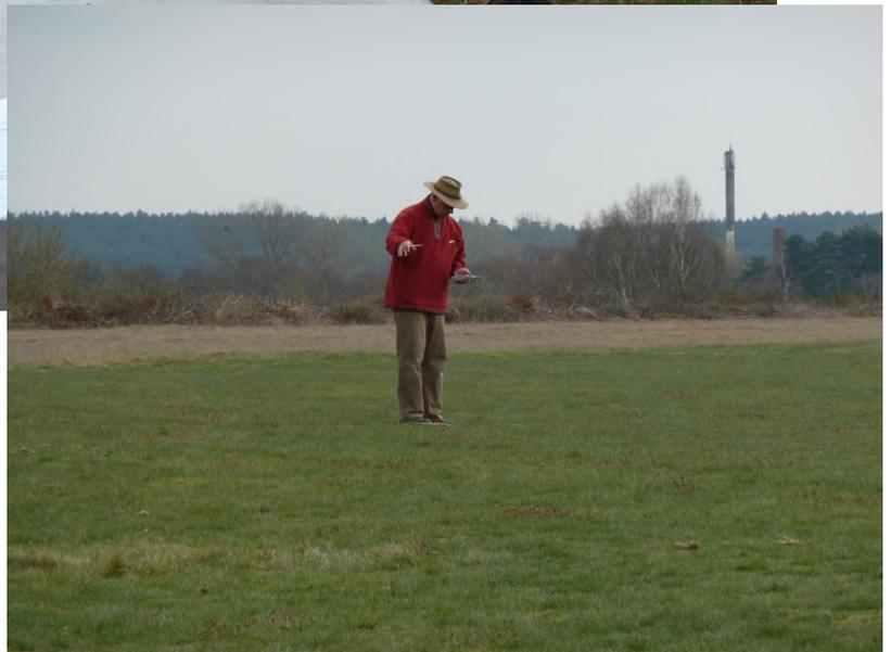
Die Messungen nach den Vorgaben der Lärmvorschrift für Luftfahrzeuge (LVL) wurden unter drei verschiedenen Winkeln mit 25m- Abstand vom Modell, welches hierzu mit Vollgas lief, durchgeführt. An diesem Tag wurden 9 Flugmodelle vermessen. Keines der Modelle überschritt den vorgegeben Grenzwert von 82 dB(A).
